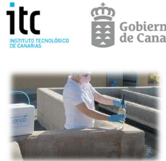
**Parámetros analizados:** DBO, DQO, SS, Nt, Pt + Microbasuras (5mm-25 µm): contaje, clasificación y caracterización.
